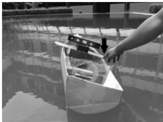
Gambar 5. Penekanan sheer pada salah satu sisi kapal model
