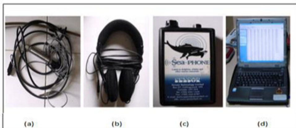
Gambar 4. Set alat perekam suara, (a) Hidrofon, (b) Headphone , (c) catu daya/baterai, dan (d) laptop untuk data logging dan data processing
